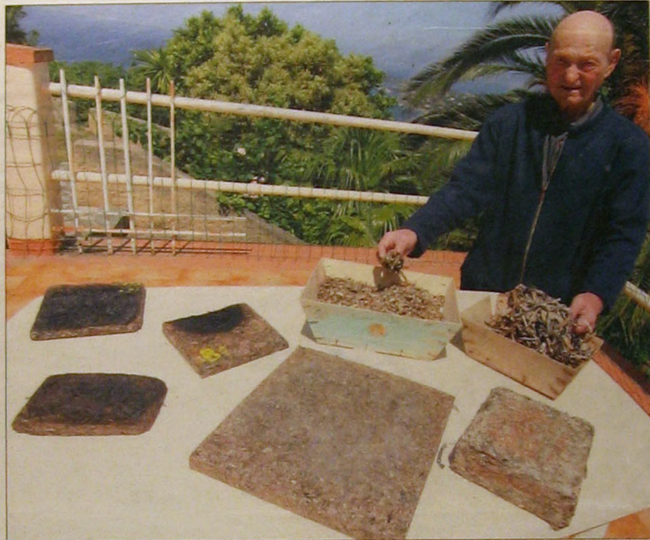
Depuis la terrasse de sa résidence sur la rive sud d'Ajaccio, Pierre Andreucci présente les plaquettes isolantes à base de posidonies qu'il a fabriquées. (Photo Pierre-Antoine Fournil)
