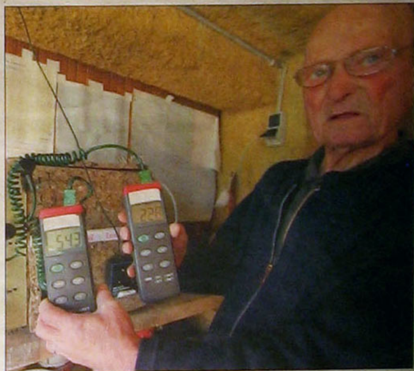
Démonstration des qualités d'isolation de la posidonie : la température est de 54,3 degrés d'un côté et n'atteint plus que 22,8 degrés de l'autre.
